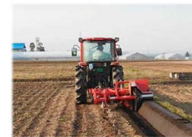
トラクターによる畦畔の嵩上げ (出典：国土強靱化民間の取組事例集)
