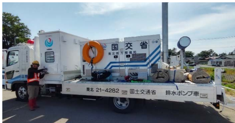
▲排水ポンプ車(国土交通省)
