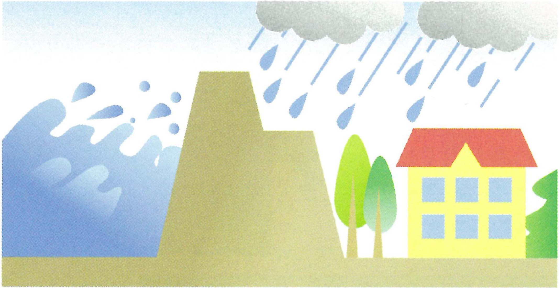
堤防（洪水を防ぐために設置した土手）
