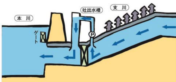
排水機場の仕組み
