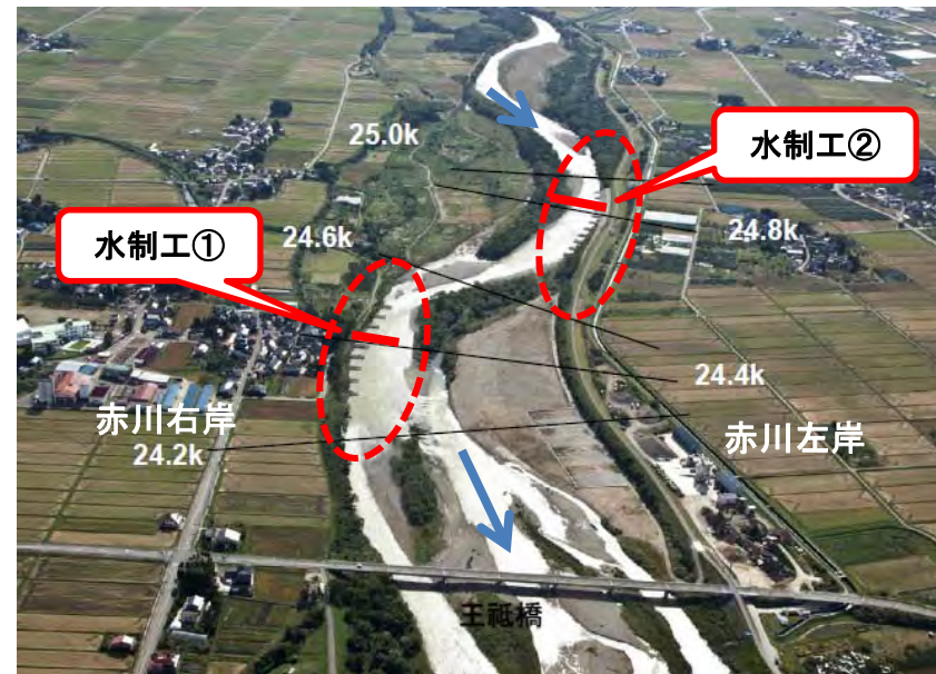
水制工実測断面位置
