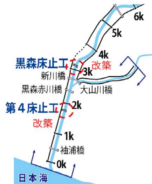
図5-3 改築が必要な床止め工
