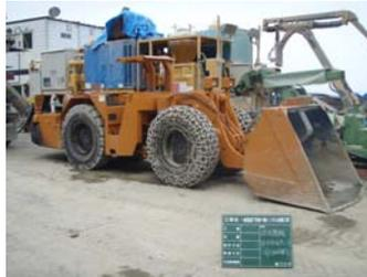
役割：掘削された岩や土砂をトンネルの外へ運び出す。なんと、運転席は横向き!
