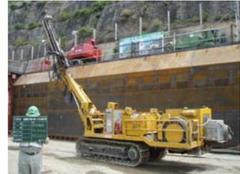
役割：ロックボルトの施工などに使用。日沿道の工事ではこの機械より大きい機械が稼働中とか...?
