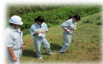
▲貫入棒を使って河川堤防の締固め度を簡便に判定する調査を実施。
