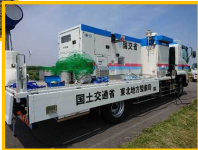
【排水ポンプ車】
