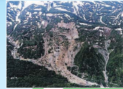
濁沢の崩壊(平成5年6月/崩壊土量約660万m 3 ) 融雪水の影響で、大規模な土砂崩壊が発生しました。この崩壊により濁沢川の流れがせきとめられ、一時、天然ダムが形成されました。
