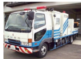
排水ポンプ車
