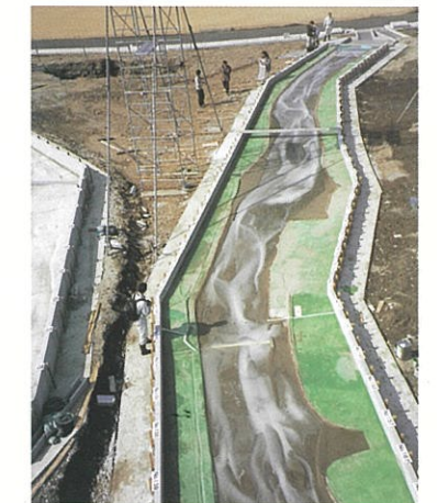
●水理模型実験 立谷沢川渓流保全工の計画にあたり、計算では解明できない現象を模型実験で再現し、より合理的な計画を目指す。
