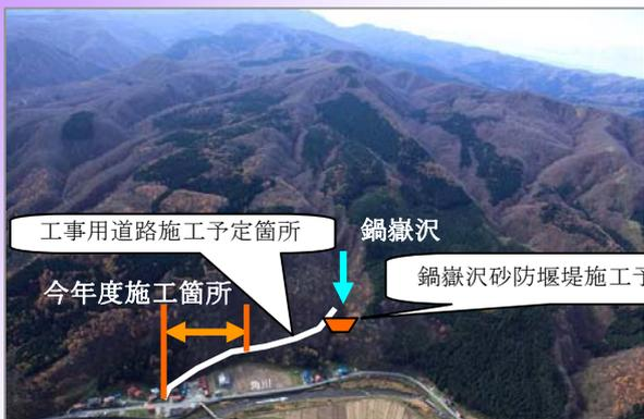
中沢地内の鍋嶽沢に土石流対策として砂防堰堤を施工するために必要な工事用道路の工事を施工していきます。今年度からの新規工事箇所です。
