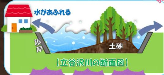
山から流れてきた土砂が川の中にたまり、木が生え、大雨等で水かさが増した時に洪水となり溢れやすくなる。それを防ぐために
