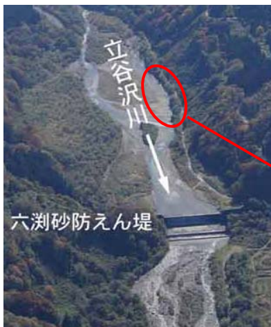
▲この一帯が堆積土砂で除石作業中
