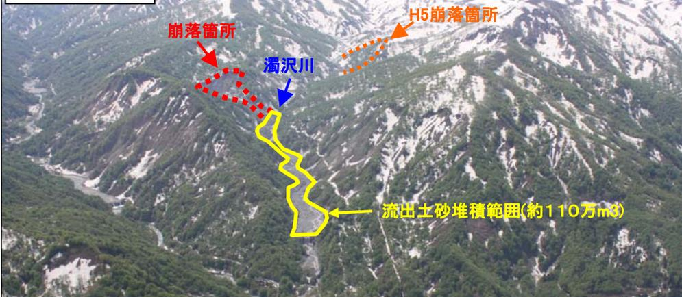
調査の結果、土砂ダムは形成されていませんでしたが、1.5km下流の濁沢第5堰堤までの濁沢川の河床に最大30m余に及び大量の土砂を堆積させ、建設中の2基を含め、5基の砂防堰堤を埋没させました。池ノ台地区以外の斜面変状は確認されず、下流域への大規模な土砂流出はありませんでした。
