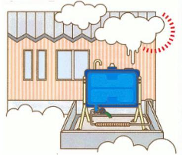
落雪によるタンク転倒や配管の破損・脱落に注意
