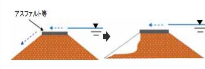
堤防天端をアスファルト等で保護することにより雨水が堤防にしみこむのを軽減するよ！
