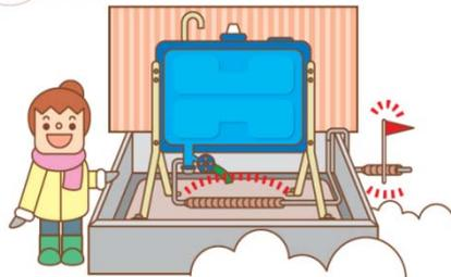
除雪による配管の破損を防ぐために目印を立てておきましょう。また、万一に備え防油堤を設置しておく安心です。
