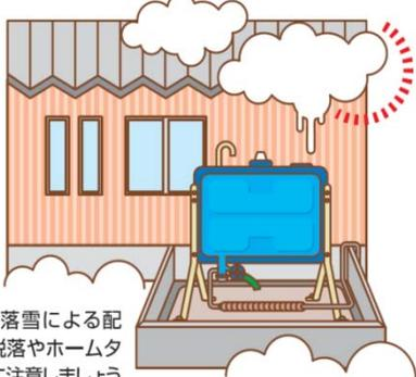
屋根からの落雪による配管の破損・脱落やホームタンクの転倒に注意しましょう。
