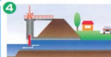
川側の水位が住宅地や田んぼのある方の水位より低くなったら、ゲートを開け水路の水があふれないように川の方に水を流します。
