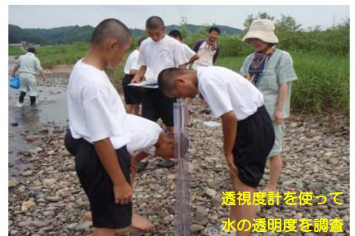
透視度計を使って水の透明度を調査
