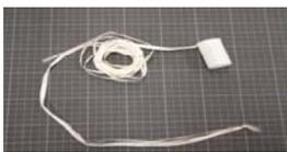
3 mの長さのひもをつけた浮き（フィルムケースで代用）を使用。ひもの端をもって浮きを水面におとし、ひもがピンと張るまでの時間を計り、流速を求めます
