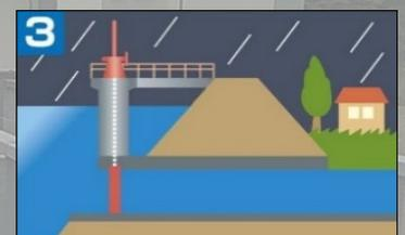
樋門・樋管の扉を閉めると、住宅側の水の行き場がなくなり、住宅地が浸水する場合があります。そのため内水被害が発生する場所には排水機場設置や、排水ポンプ車で排水するなどの対策を講じています。
