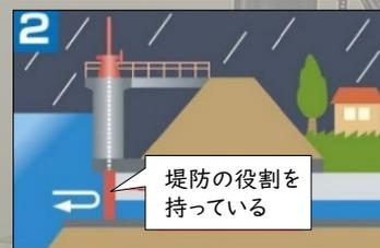
洪水により川の水位が高くなると、川の水が樋門・樋管を通して住宅側流れ込み(逆流)、浸水被害が発生するため、樋門・樋管の扉を閉めます。
