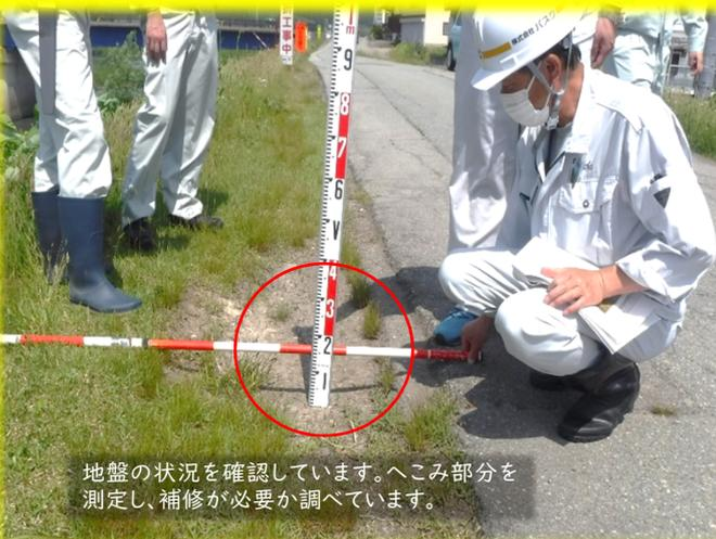
地盤の状況を確認しています。へこみ部分を測定し、補修が必要か調べています。
