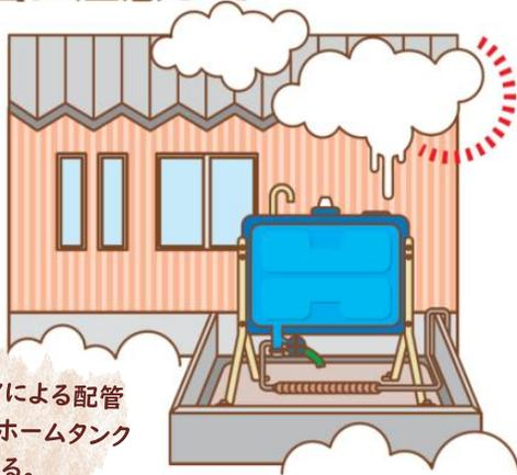
屋根からの落雪による配管の損傷・脱落やホームタンクの転倒に注意する。
