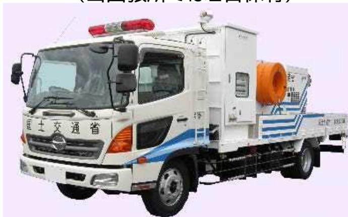
**目的:** 河川のはん濫などの浸水被害に対し、排水作業を緊急に行う車両です。
