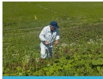
貫入棒による締め固め度の確認
