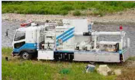
4t車のトラックにポンプ、ホース、発電機等のすべてを搭載しており、内水排除が必要な場所にその都度移動し、設営はすべて人力で行うことができます。
