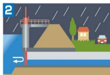
②大雨の影響で川の水位が高くなると川の水が住宅側へ逆流してしまうため、樋門の扉を閉めます。
