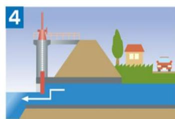
④川の水位が低くなり、住宅側への逆流の心配がなくなったら、樋門の扉を開き、住宅側に溜まった水を川へ流します。
