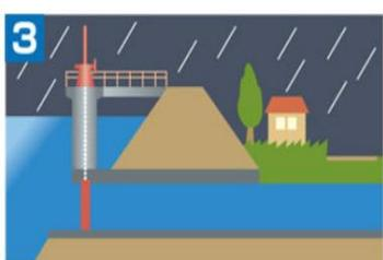
③洪水時に樋門の扉を閉めると住宅側の水の行き先がなくなり住宅側が浸水する恐れがあります。そのため、排水機場を設置したり排水ポンプ車で排水する等の対策をします。
