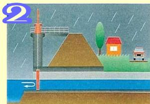
2 川の水の高さが住宅地や田畑のある方と同じ高さになったら、水が反対に流れ出さないようにゲートを閉めます。
