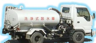
土砂を積んだダンプトラックが公道を走るため、洗淨式散水車を使用し、砂ほこりが舞うのを防いだり、道路を清掃したりしています！
