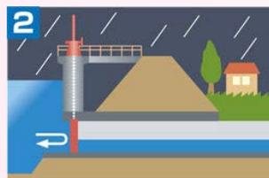
川の水が住宅地側に逆流してくるのでゲートを閉めます。
