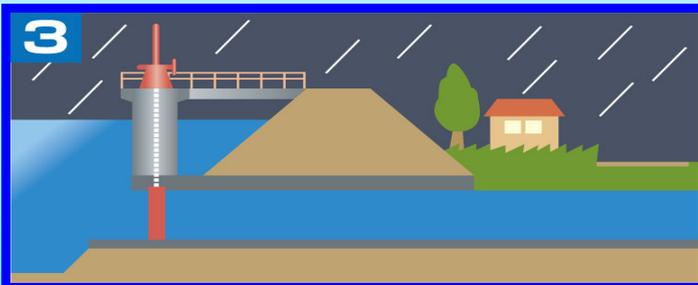
▲ 樋管の扉を閉めると、住宅側の水の行き場所がなくなり、住宅地が浸水する(内水被害)場合があります。そのため、内水被害が発生する場合には排水機場を設置したり、排水ポンプ車で排水するなどの対策を講じています。
