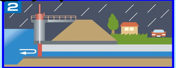
▲ 洪水により川の水位が高くなると、川の水が樋管を通して住宅側に流れ込み(逆流)、浸水被害が発生するため、樋管の扉を閉めます。
