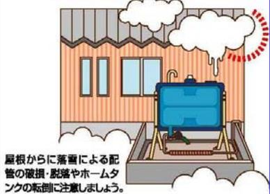
屋根から落雪による配管の破損・脱落やホームタンクの転倒に注意しましょう。
