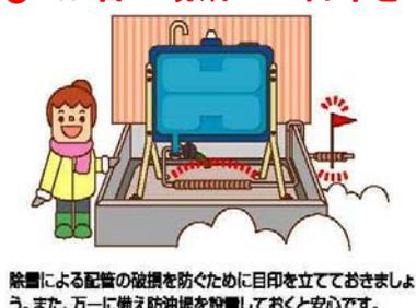
除雪による配管の破損を防ぐために目印を立てておきましょう。また、万が一に備え防油堤を設置しておく安心です。
