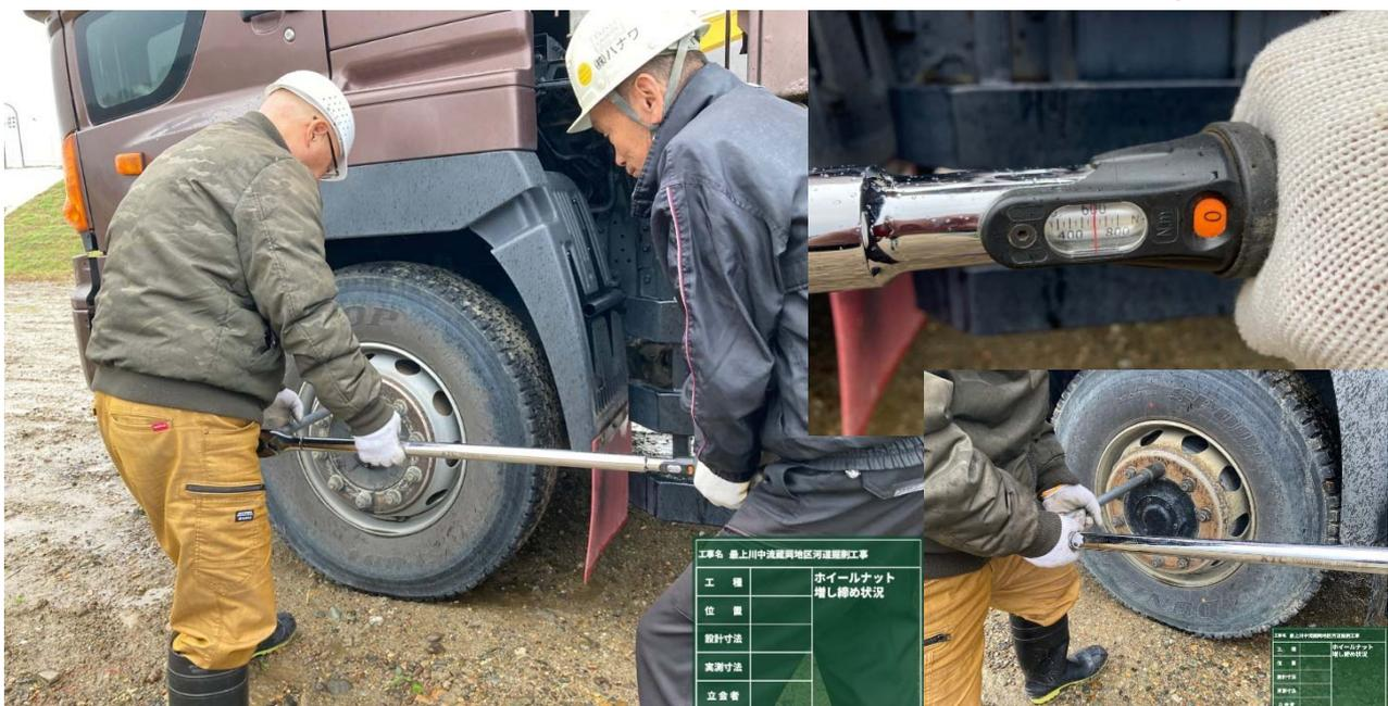
前頁のホイールナットの増締め後に、ナットの緩みの確認が安易に出来るように、ホイールナットマーカを装着し運行前点検を実施しています。
