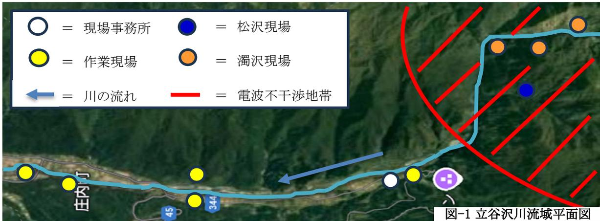
本工事は電波状況が悪い場所での作業となり、連絡や緊急時の対応を即座に行うため、昨年からは衛星を利用した高速インターネットサービスを導入した。しかし、本工事は災害の影響で道路、法面の崩壊の被害があり復旧する必要があった。それに伴い施工箇所が期間にもよるがだいたい約2kmの範囲で点在して、電波の届かない範囲が広域となってしまった。また大雨による災害発生の影響で、現場
