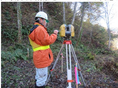
図-7 地上レーザー計測状況
