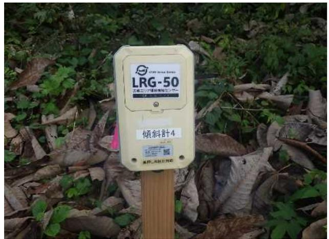
広域傾斜検知システム(傾斜センサ)
