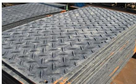
② 縞鋼板加工された敷鉄板
