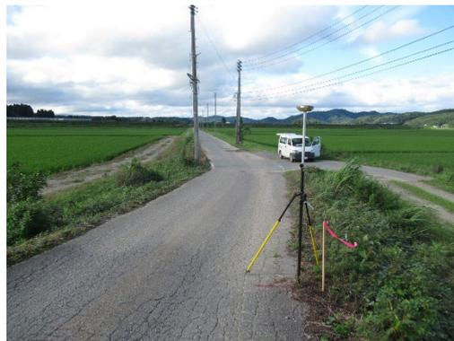
図-9 ネットワーク型 RTK 観測状況
