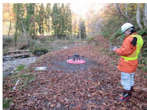
図-8 UAVレーザー計測状況
