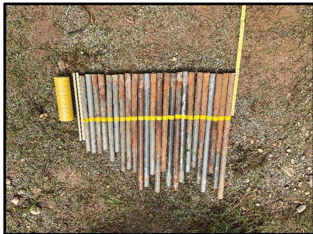
写真 3 支柱の20cmの長さにマーキング
