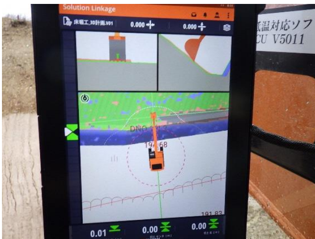
【ICT 施工時のバックホウ内モニターの様子】
