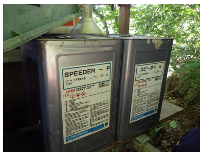
写真-8 掘削に使用した泥水材
