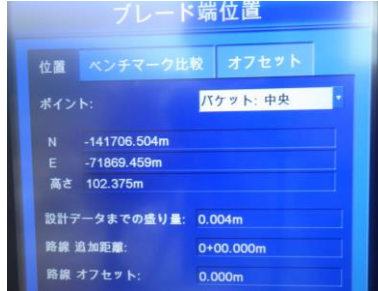
ICTバックホウ位置確認 ブレード端位置
