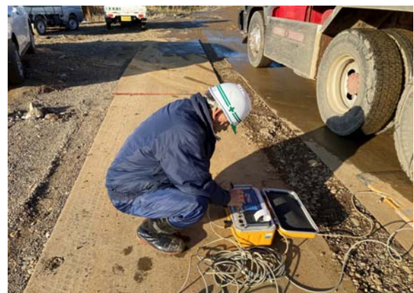
【 トラックスケールによる過積載測定状況 】
