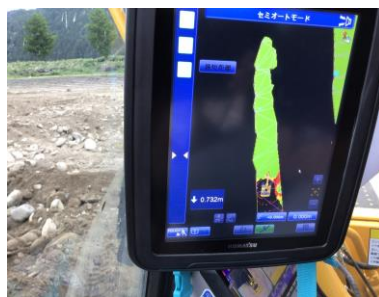
ICTバックホウ位置確認 ブレード端位置
