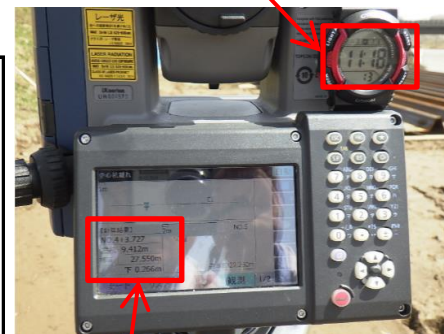
トータルステーションで測定 (測点・CL離れ・基準高)
