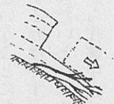
面発生表層雪崩（破断面）
