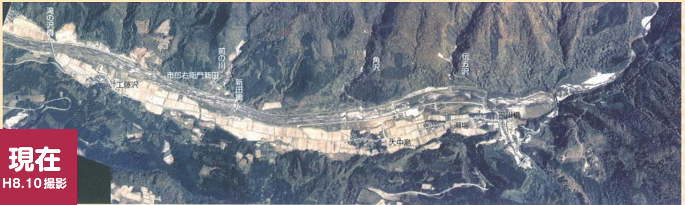
平成8(1996)年 立谷沢川空中写真(流路工の砂防工事により、川の流れが定まり、まわりが農耕地として利用されている)
