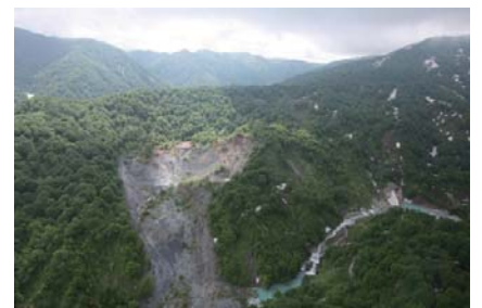
平成23(2011)年に濁沢で起きた地すべり性の深層崩壊(写真提供: 山形大学・八木浩司教授)
