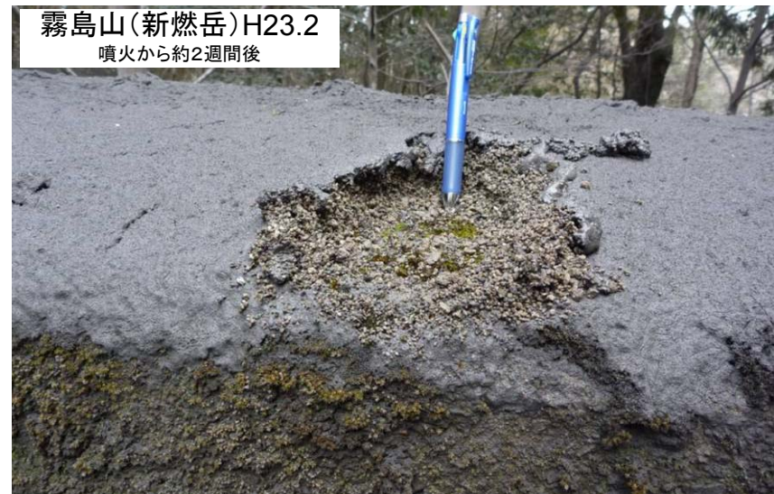
霧島山(新燃岳)H23.2 噴火から約2週間後 火山灰による皮膜の状況 降灰深は小さいが、表面の火山灰が固結し皮膜を形成
