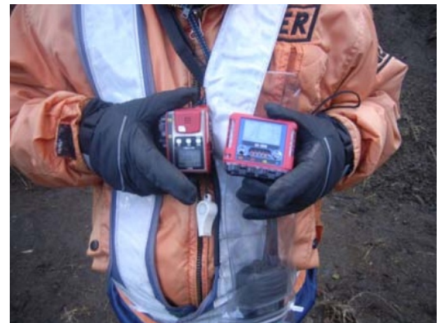
霧島山(新燃岳)噴火時に現場代理人が携帯したガス検知器
