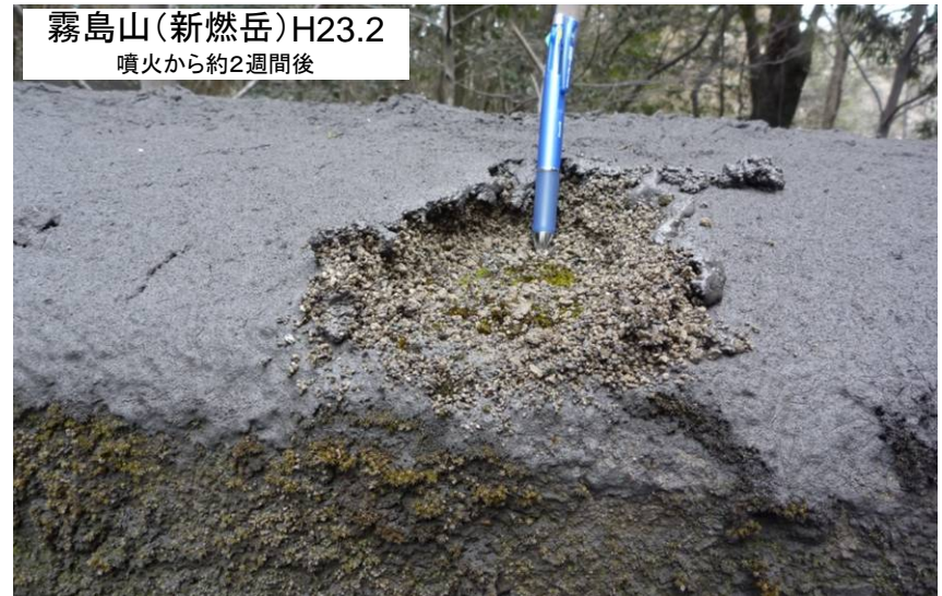
火山灰による皮膜の状況 降灰深は小さいが、表面の火山灰が固結し皮膜を形成
