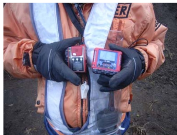
霧島山(新燃岳)噴火時に現場代理人が携帯したガス検知器
