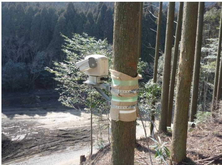
霧島山(新燃岳)の緊急対応で設置された可搬型監視カメラ
