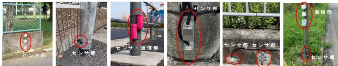
実証実験で設置した浸水センサの設置事例
