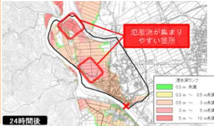
<排水箇所の検討(大石田、豊田工区)>
