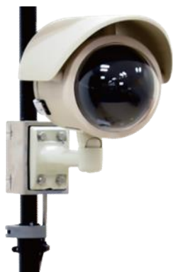
設置した簡易型河川監視カメラ
