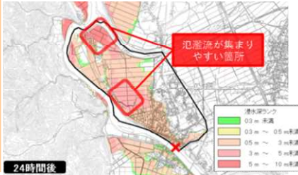
<排水箇所の検討(大石田、豊田工区)>
