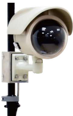
設置した簡易型河川監視カメラ
