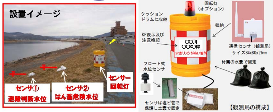
水害リスクが高い箇所を監視するための簡易アラート装置
