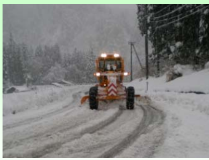
除雪グレーダ 路面にできた圧雪を排除します
